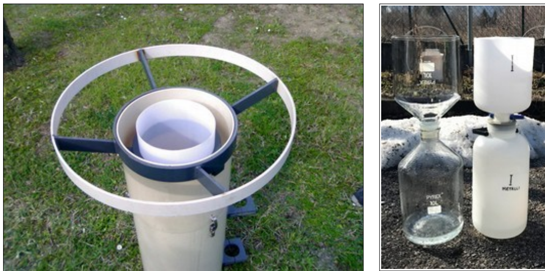
Fig. 2.5: Deposimetro di tipo “bulk” e bottiglie di raccolta in polietilene e vetro pyrex.
