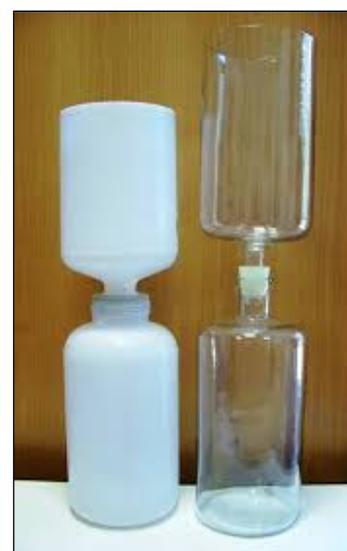
Fig. 2.5: Deposimetro di tipo “bulk” e bottiglie di raccolta in polietilene e vetro pyrex.
