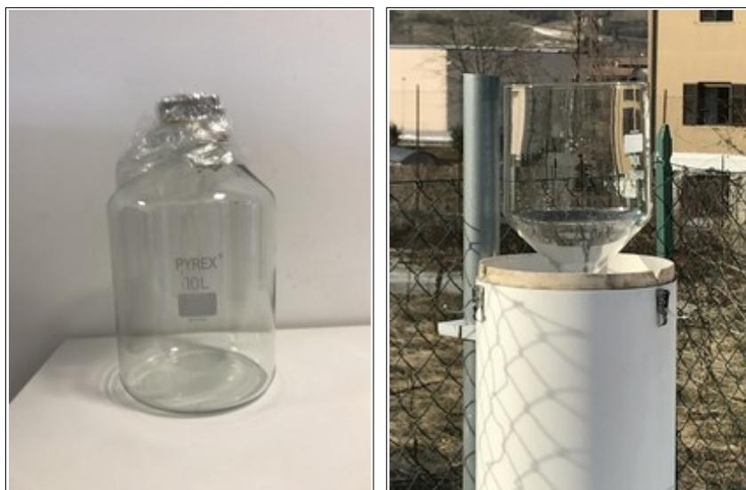
**Fig. 2.6: Sistema di raccolta delle deposizioni di PCDD/F e PCB.**
