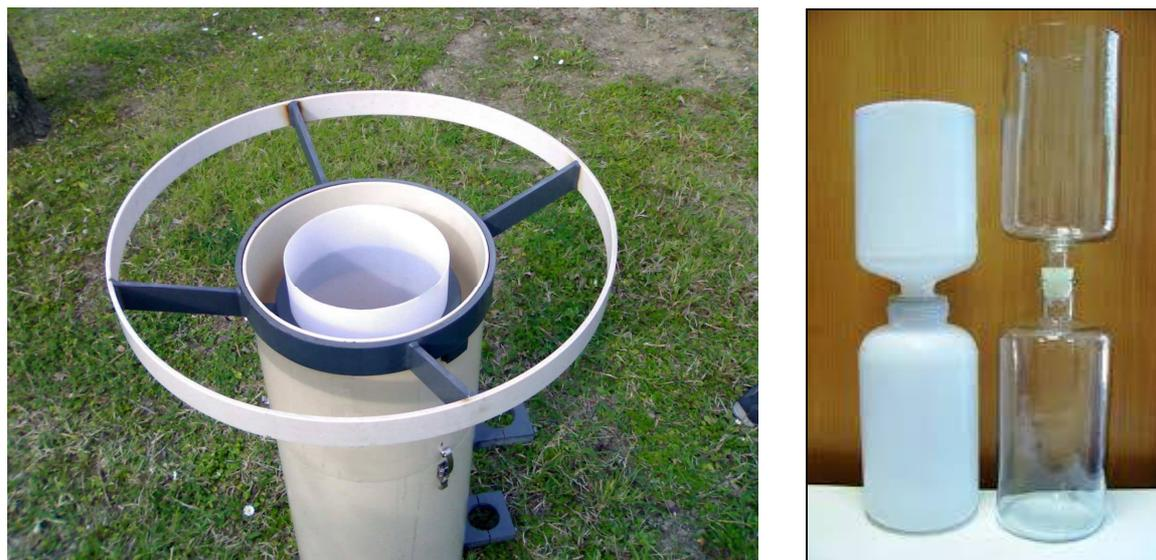
Fig. 2.6: Deposimetro di tipo “bulk” e bottiglie di raccolta in polietilene e vetro pyrex.
