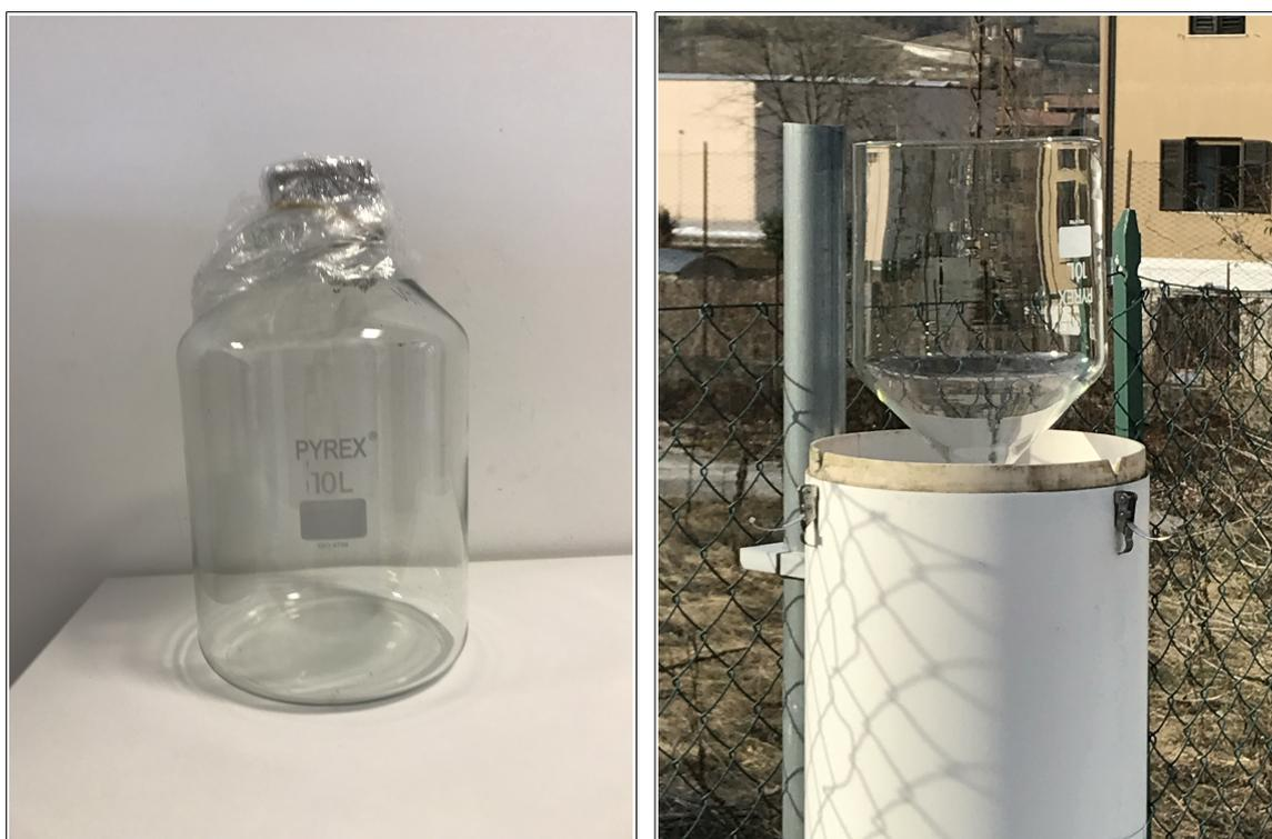
**Fig. 2.6: Sistema di raccolta deposizioni di PCDD/F e PCB.**
