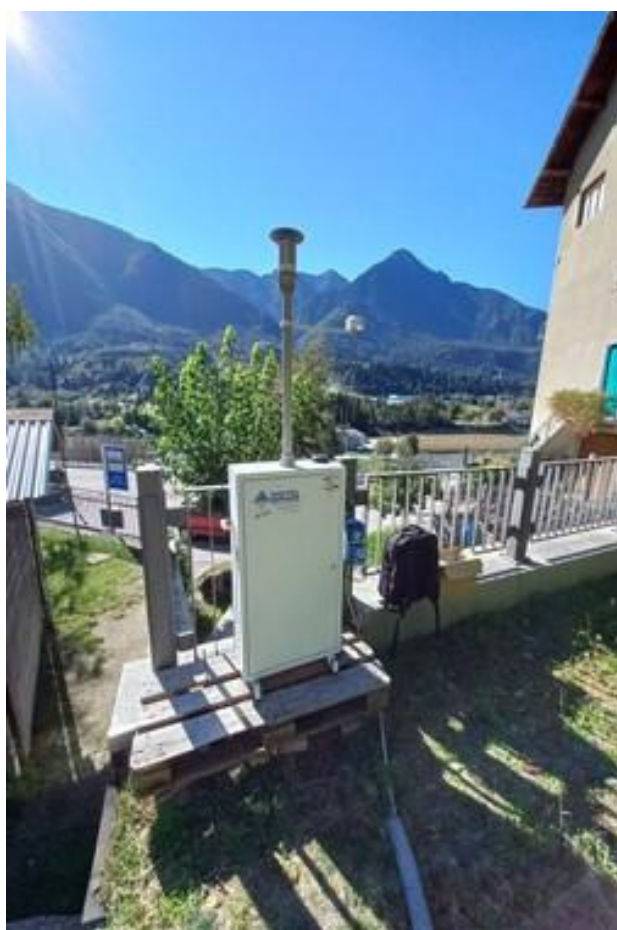
Figure 8 e 9: posizionamento del campionatore di polveri sottili PM10 nel giardino della scuola dell'infanzia di Preore di Tre Ville
