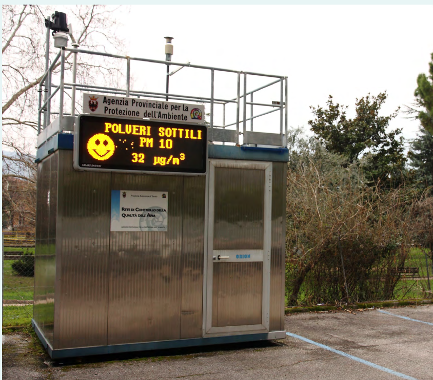
Stazione di qualità dell'aria di Riva del Garda (foto: APPA PAT).
